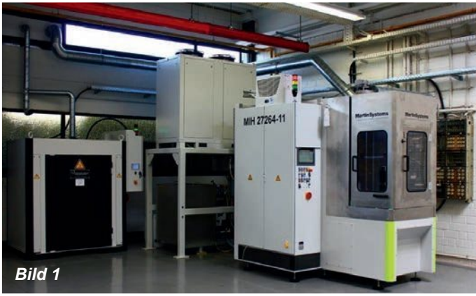
Bild 1: Induktionshärtemaschine Arbeitsbereich: Durchmesser 800 mm, Länge 1.000 mm Anlassofen 1.000 mm x 1.000 mm x 1.200 mm
